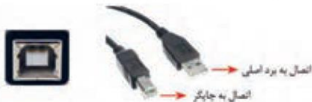
شکل ۱۹- درگاه اتصال USB به چاپگر و کانکتورهای دوسر کابل
